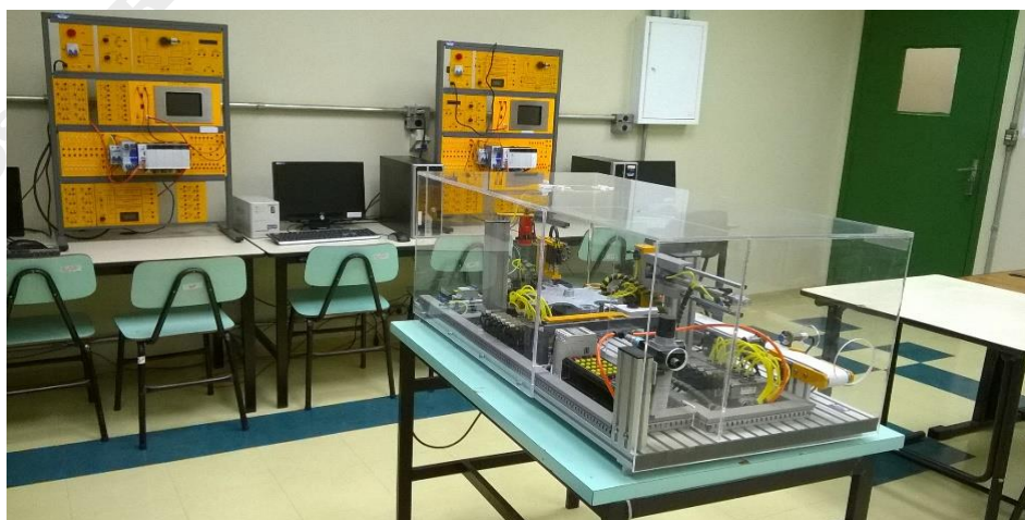
Figura 4- Minicélula didática de fabricação instalada no Laboratório de redes de CLPs, no Campus São Paulo
