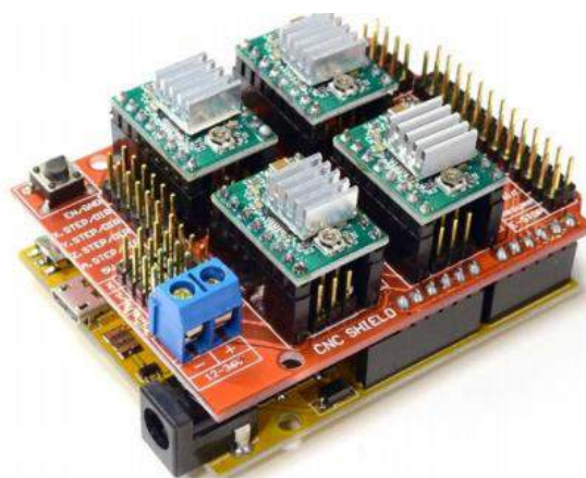
Figura 6 - Placa de expansão CNC Shield v.3 acoplada no Arduino UNO.
